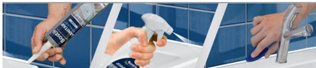
Відріжте кінчик картриджа над різьбленим, відріжте носик під кутом 35° / 45° до ширини стику. Прикрутіть носик до кінчика картриджа. Для легкого та чистого нанесення захистіть стик з боків клейкою стрічкою. Зніміть стрічку відразу після нанесення герметика. Нанесіть Bostik Smoothing Spray на свіжий герметик. Сформуйте шов за допомогою шпателя Bostik Perfect Seal. Знову нанесіть спрей і вирівняйте герметик не пізніше 8 хвилин після нанесення.
